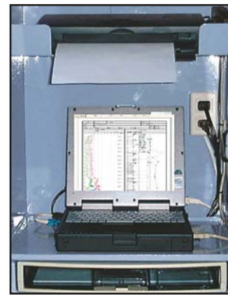
パワーユニットにPCを接続し、リアルタイムに圧入状況を把握
